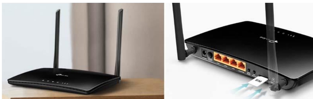
Imagen 14. Router 4G. La tarjeta SIM se inserta en la parte trasera del dispositivo.
